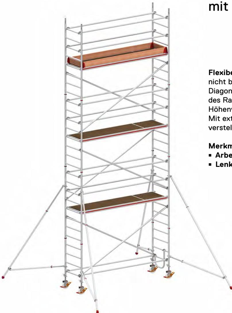
**Flexibel überall einsetzbar:** Der Aufbau könnte nicht bequemer sein – komfortables Auflegen von Diagonalen und Bühnen auf derselben Sprosse des Rahmenteils. Außerdem: optionaler Aufbau mit Höhenversatz, beispielsweise in Treppenstellung. Mit extrem großflächiger Bühne und vier höhenverstellbaren Lenkrollen.
