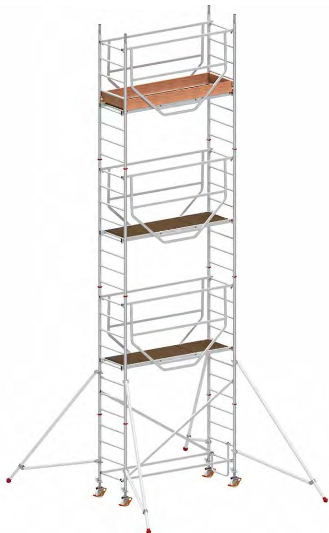
**Maximal sicher, überzeugend komfortabel:** Höchste Sicherheit in jeder Phase des Aufbaus dank SAFE-T-Sicherheitsgeländer, das bereits von unten eingehängt wird. Teleskopierbare Ausleger mit Bajonett-Verschluss bei 9,27 Meter Reichhöhe zum Ausgleich von Bodenunebenheiten. Wetter- und rutschfeste großflächige Bühne. Mit vier höhenverstellbaren Lenkrollen.
