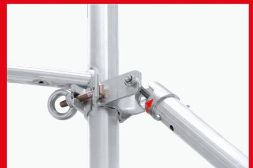
Bajonett-Ausleger bei größeren Aufbauhöhen inklusive: Der Bajonett-Verschluss am oberen Teil des Auslegers wird einfach und bequem in die am Rahmenteil befestigte Kupplung eingedreht und kann so vom Boden aus montiert werden.
