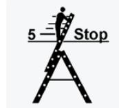
Mehrzweckleitern in der Gebrauchsstellung „Stehleiter mit Steckteil“ dürfen nur bis zur **fünftobersten Sprosse** bestiegen werden.
