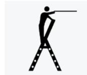
Die Größe von Stehleitern mit Plattform sowie von Podestleitern muss so gewählt werden, dass der Benutzer die maximal erforderliche Arbeitshöhe **ohne sich zu recken** von der Plattform aus erreichen kann.
