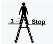
Beidseitig besteigbare Stehleitern dürfen nur bis zur **drittobersten Stufe/Sprosse** bestiegen werden, damit ausreichender Halt möglich ist.
