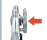
Die Gelenke rasten automatisch ein, wenn die gewünschte Position erreicht ist. In Stehleiterposition lässt sich die Leiter dennoch ohne nochmaliges Öffnen der Gelenke schließen.
