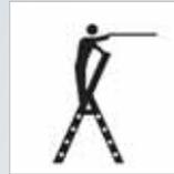
› Die Größe von Stehleitern mit Plattform sowie von Podestleitern muss so gewählt werden, dass der Benutzer die maximal erforderliche Arbeitshöhe **ohne sich zu recken** von der Plattform aus erreichen kann.
